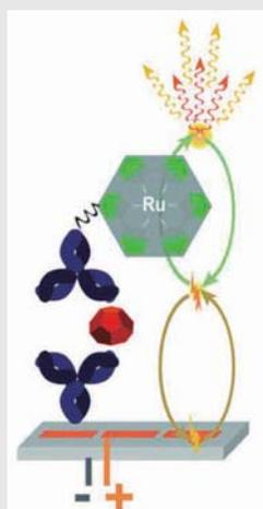
圖4. ECL 運作示意圖，藉由電流刺激標定在蛋白質藥上的鈦元素不斷產生氧化還原反應，以達到檢測ADA並放大訊號的目的<sup>[9]</sup> (Analyst. 2015, 140 (18):6175-6194.)。
